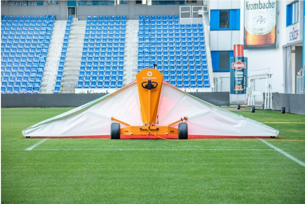
Das automatisch ausfahrbare Zelt sorgt für eine effiziente Verteilung des Lichts und der Wärme.
